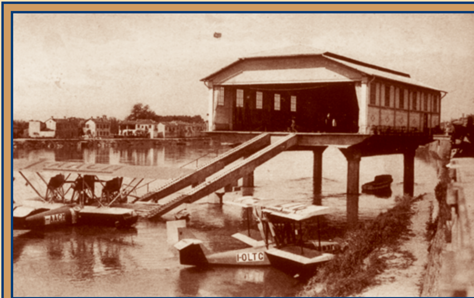
1930 - Idroscalo di Pavia. Accanto allo scivolo di sollevamento idrovolante CANT 22 "S. Carlo" immatricolato AACM (trimotore) in servizio dal 1930 al 1937. Ormeggiato lungo la riva l'idrovolante CANT 10 ter immatricolato OLTG (monomotore) in servizio dal 1926 al 1930.
