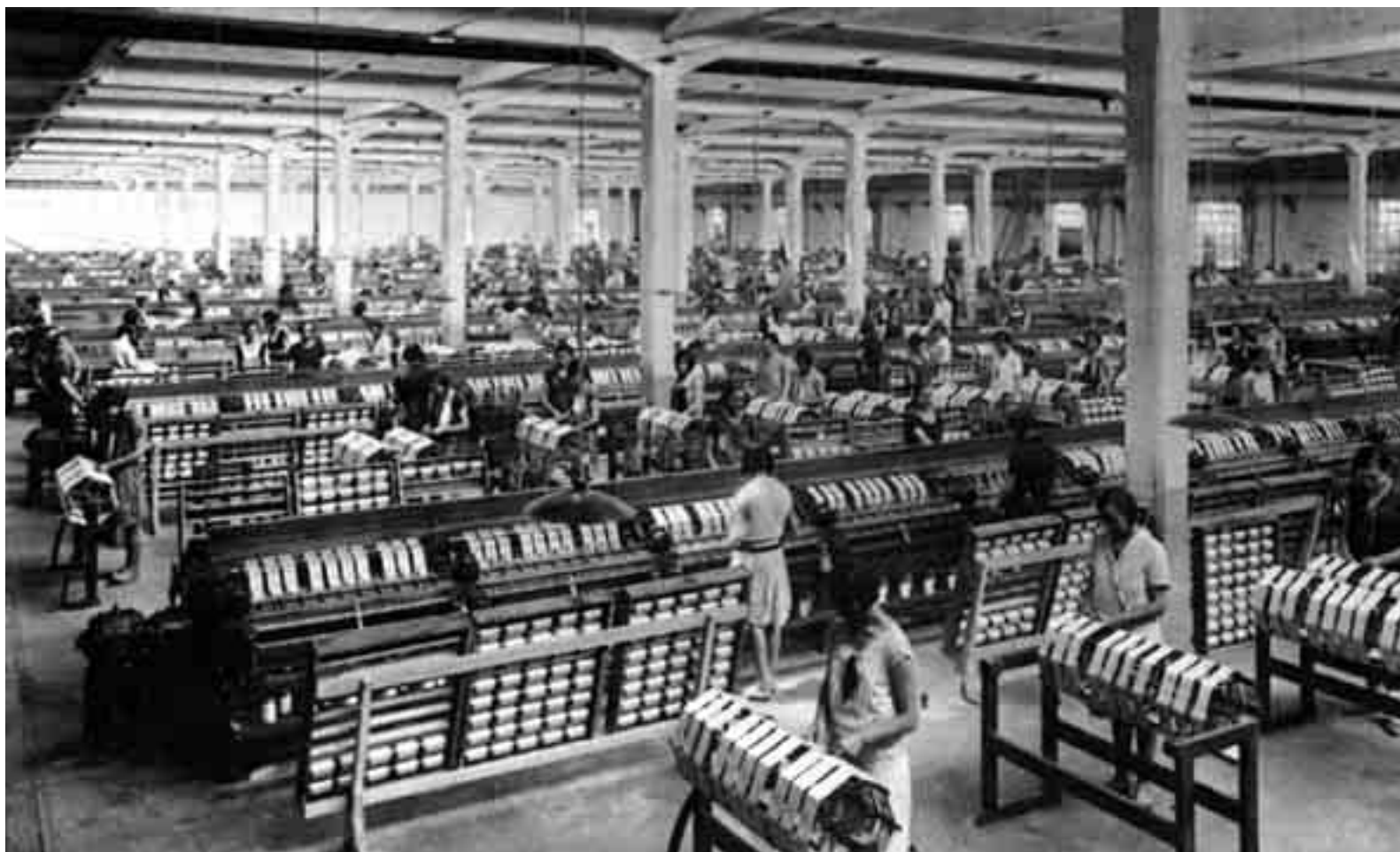
Snia Viscosa. Sala di aspatura per convertire il filato in rocchetti in matasse.
